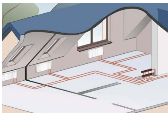
Układ rozdzielaczowo-trójnikowy w instalacji grzewczej
