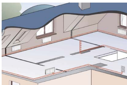
Układ pętlicowy instalacji grzewczej dwururowy
