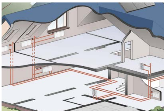
Układ „pionowy” instalacji grzewczej
