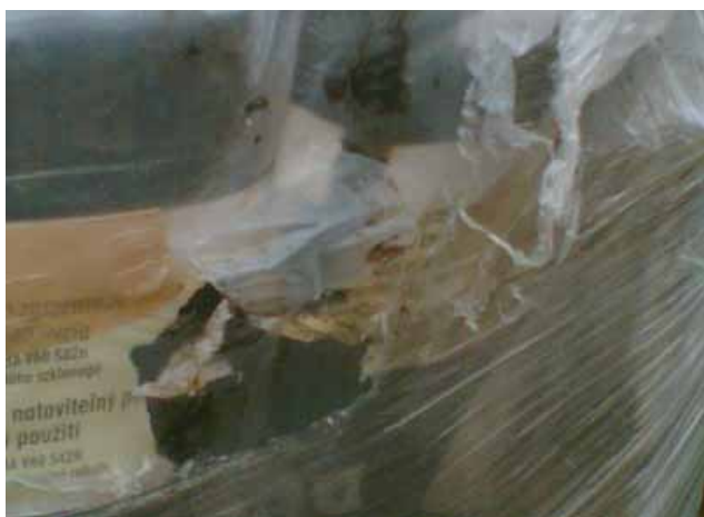
Fot. 21 Uszkodzone widlakiem rolki
